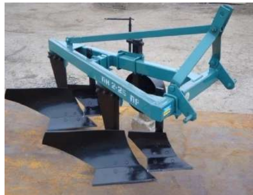
ნახ. 4.1 გუთნის სამუშაო ორგანოები: 1-დისკური დანა; 2-წინმხვნილი; 3-სახნისი; 4-ველის ფიცარი; 5- ნიადაგდამაღრმავებელი; 6- ფრთა; 7-დამაღრმავებელის დგარი; 8-კორპუსის დგარი; 9-გუთნის ჩარჩო.
