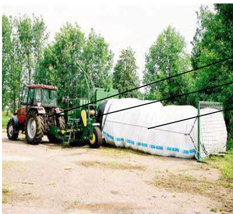
სურ. 6. ა) სილოსისა და სენაჟის ჩადება პოლიეთილენიანი აფსკის ათეული მეტრის სიგრძის ტომარაში, ბ) ტომარა საესე სასენაჟე მასით. 1-ტრაქტორი, 2 - სენაჟის ჩამდები მანქანა; 3 - სასენაჟე მასის ჩასადები პოლიეთილენის აფსკიანი ტომარა; 4 - სასენაჟე და სასილოსე კოშკი.
