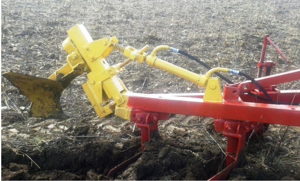
სურ. 18. ექსპერიმენტული გუთნის მოდების განის ცვალებადობის მექანიზმი.
